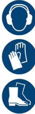
Diese persönliche Schutzausrüstung muss für das Bedienen und Einstellen der Maschine bereitgestellt und getragen werden:
